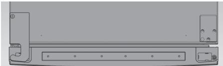
Finallement, vérifiez le bon alignement des portes et leur fermeture hermétique. Si nécessaire, ajustez les pieds ajustables de l'avant afin d'obtenir un positionnement bien horizontal de l'appareil.
